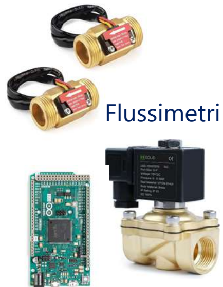
Regolatore di portata e logica di controllo
